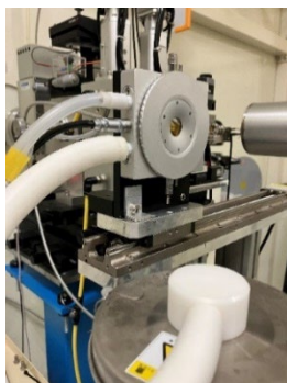
図 加熱・冷却ステージを用いた測定の様子 (左) と各ステージ温度における感温性ゲルのSAXSプロファイル (右)
